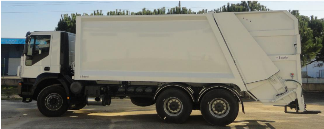
Superestrutura BASRIO com 22m 3 capacidade em Chassis IVECO Trakker AD380T38H
